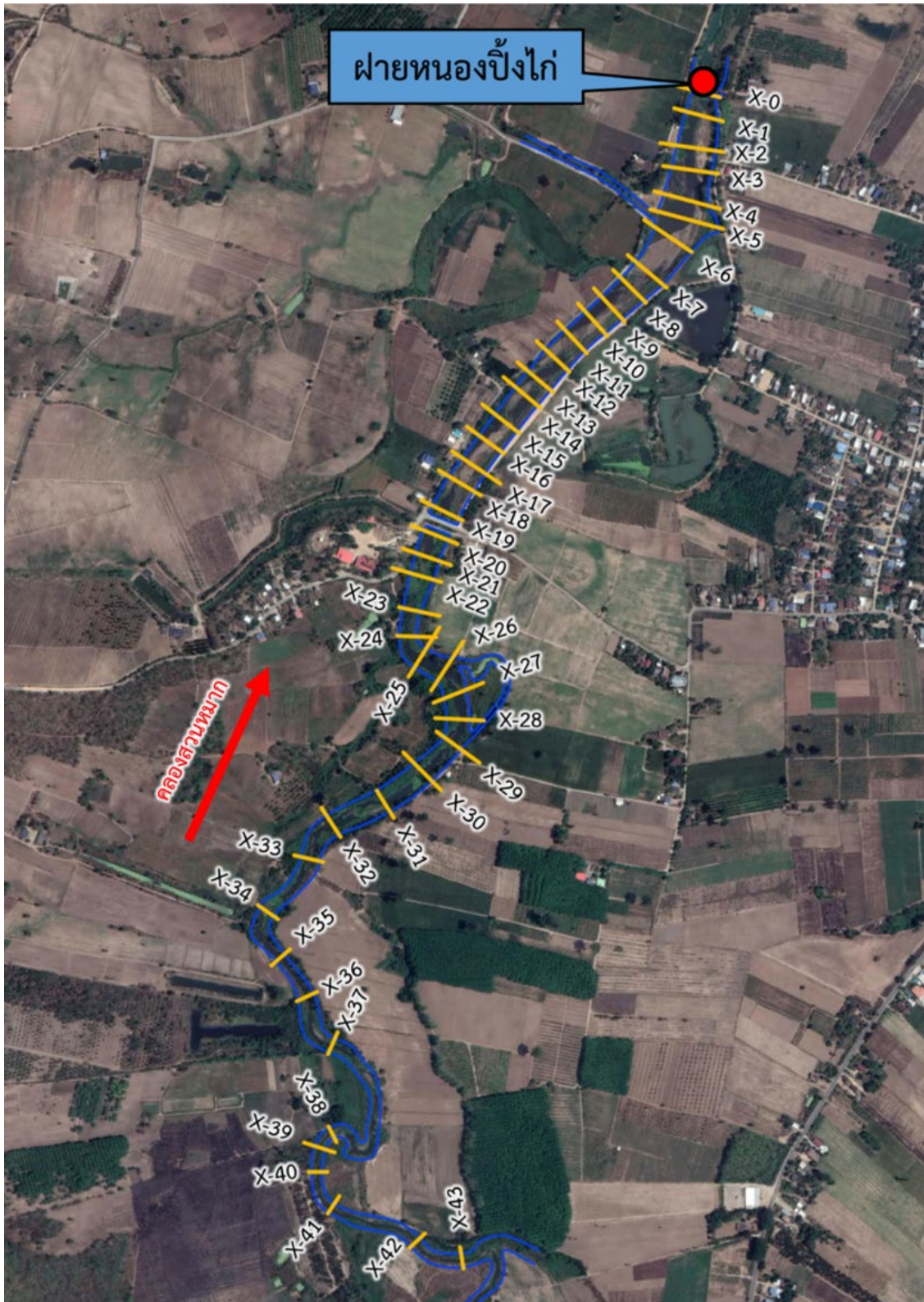
รูปที่ 8 ตำแหน่งหน้าตัดที่สำคัญเพื่อเปรียบเทียบหน้าตัดก่อนและหลังฤดูฝน
